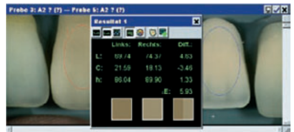
Abb. 2: Die mit SpectroShade (MHT, CH-Niederhasli) gemessenen Farbunterschiede der Farbmuster in Abb. 1 liegen bis \Delta E = 6 auseinander. Das ungeübte menschliche Auge erkennt Farbunterschiede bereits bei \Delta E \approx 2 .
