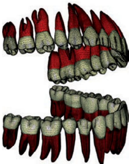
Abb. 3b: Mit finiten Elementen vernetzte Zähne im Ober- und Unterkiefer.
