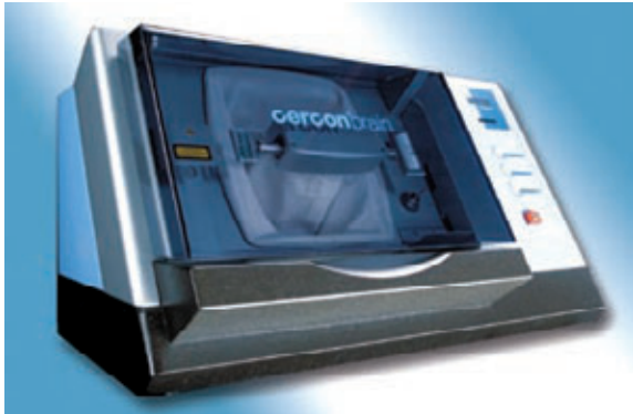
Abb. 4: Der optische Laserpunkt Stylus findet u. a. in der Scan- und Fräseinheit Cercon brain seinen Einsatz.
