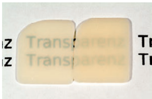
Abb. 2: Die PS e.max CAD-Scheiben nach der Kristallisierung im Keramikofen. Das Material hat nicht nur seine Festigkeit sondern auch die Dentinfarbe durch die Kristallisation erhalten.
