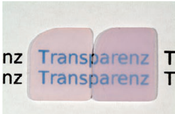
Abb. 1: 0,5 mm und 0,8 mm dünne Scheiben von IPS e.max CAD MO, Farbe 1, nicht kristallisiert. Bemerkenswert ist die hohe Transparenz und das offensichtliche Fehlen von Metalloxiden zum Einfärben der Keramik.
