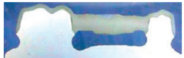
Lichtmikroskopische Aufnahme: Der Schnitt zeigt die Passgenauigkeit der dreigliedrigen Lava-Brücke von 35 bis 37.
