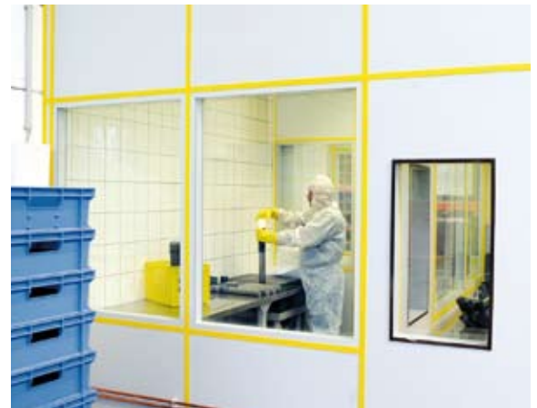
Abb. 10: Das Abfüllen der Rohstoffe erfolgt unter strengsten Sicherheitsmaßnahmen, um Verunreinigungen zu verhindern.
