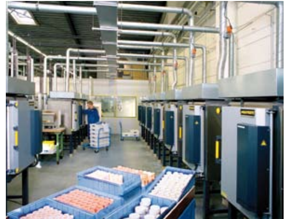
Abb. 9: Insgesamt 14 Sinteröfen werden ausschließlich für die Produktion der Weißlinge eingesetzt.
