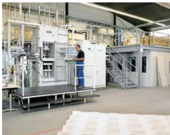
Abb. 14: Das Material wird mit Hochleistungspresen bei einem Druck von bis zu 6.000 bar zu Rohlingen verpresst.
