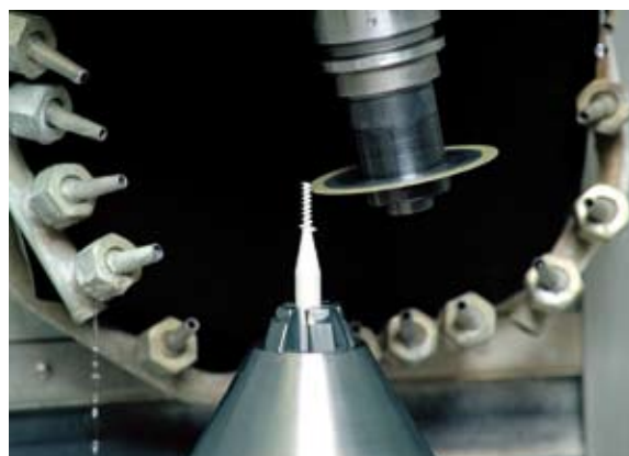
Abb. 4: Es werden u. a. medizinische Bauteile wie Mikrodosierschnecken für Medikamente gefertigt.
