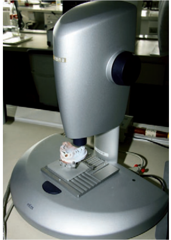
Lackierte Modelle der Meisterschüler konnten dank Verwendung von Scanpuder dennoch eingescannt werden.
