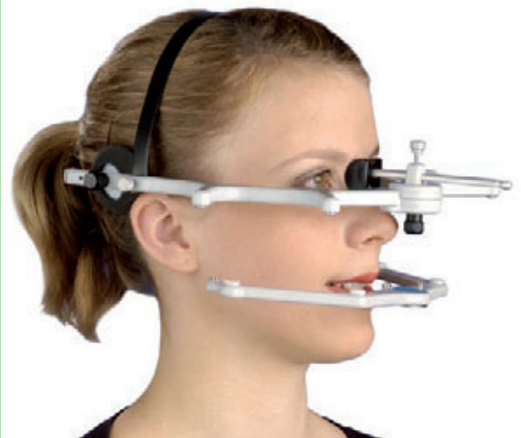
Abb. 5: Der Schallsender des JMA wird paraokklusal am Unterkiefer fixiert. Am Kopf des Patienten wird eine Mikrofon-Sensor-Einheit befestigt.
