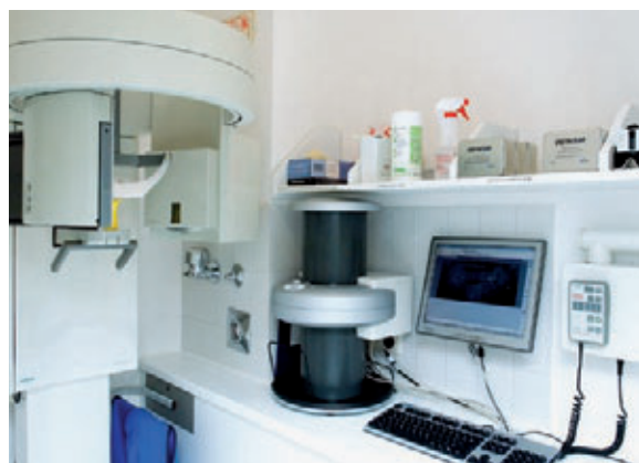
Beim Röntgen setzt Dr. Akpan auf einen Speicherfolien-scanner.
