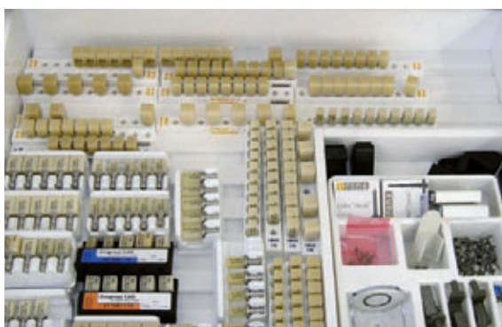
Verarbeitet werden Feldspat- und Glaskeramikblöcke.
