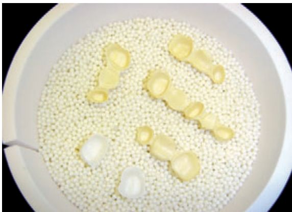
Brücken- und Kronengerüste aus Zirkoniumdioxid auf einer Sinterunterlage aus Granulatperlen.
