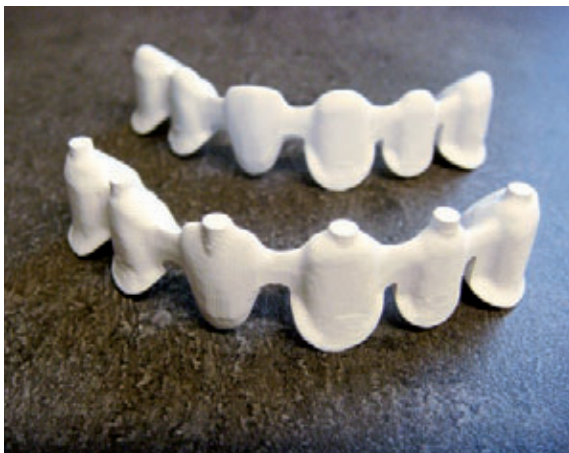
Brückengerüst mit (vorne) und ohne (hinten) Sinterdrops.
