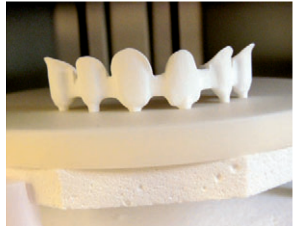
Brückengerüst mit Sinterdrops auf einer Sinterscheibe.
