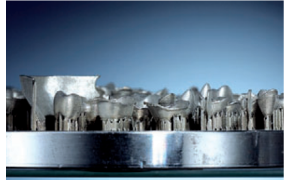
Abb. 9: Im SLM-Verfahren wird Chrom-Cobalt-Pulver schichtweise aufeinander geschmolzen.
