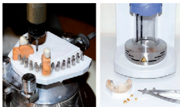
Auf Wunsch übernimmt das Fräs Zentrum das Nachfräsen von Primärkronen (I.) und das Herstellen von Sekundärkronen.
