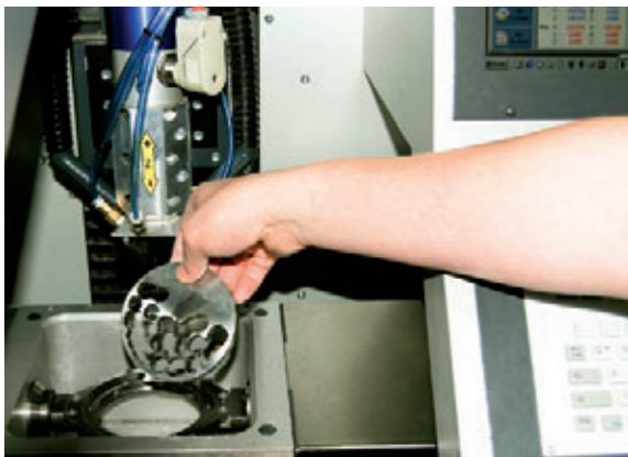
Mit der Fräseinheit ZENO® 3020 können auch die Titan- und NEM-Rohlinge verarbeitet werden.
