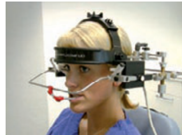
Bild 5: Condylcomp am Proband
