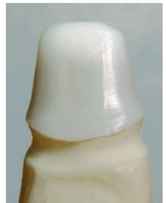
Abb. 7: Die Farbe des Gipsstumpfes scheint durch das transluzente Zirkondioxid (Oratio).
