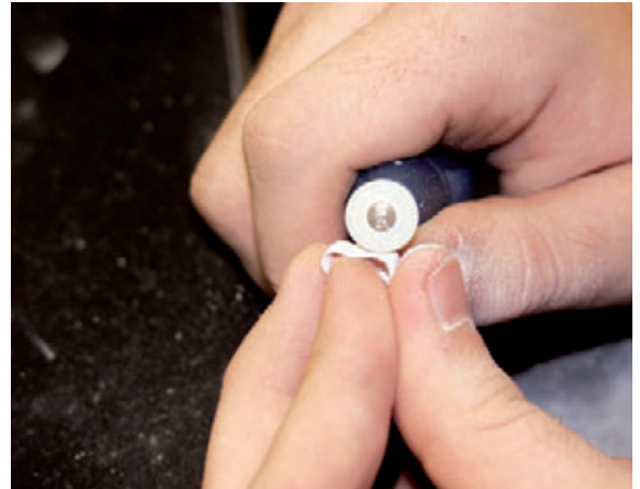
Abb. 5: Vor dem Einfärben werden die Gerüstarbeiten von Hand ausgearbeitet.
