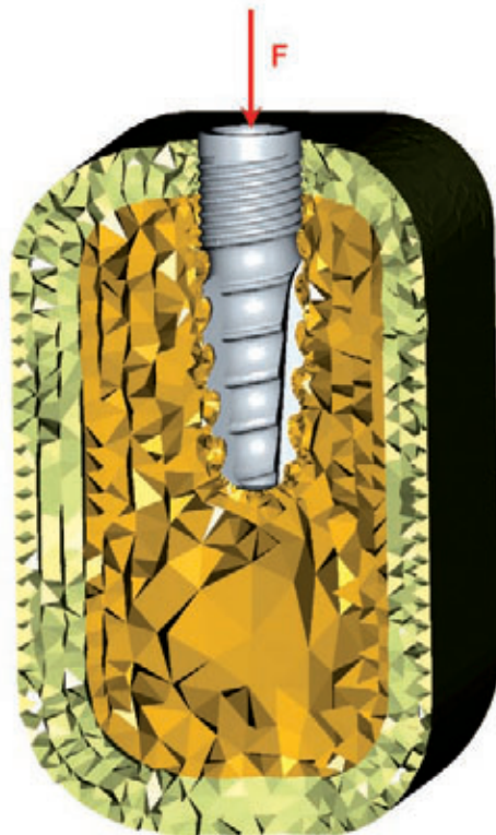
Abb. 9b: Die Implantate wurden in idealisierte Knochen-segmente inseriert und mit einer vertikalen Kraft von 100 N belastet.
