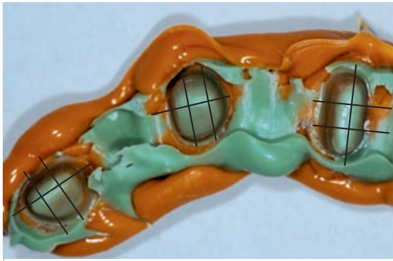
Abb. 7: Beispiel einer Replika: Das grüne, dünn fließende Silikon dokumentiert die Diskrepanz und damit die klinische Passung zwischen Pfeilerzahn und Kronenlumen. Die Stabilisierung der dünnen Silikonschicht erfolgte mittels Putty-Material. Die eingezeichneten Linien geben die transversalen und horizontalen Schnittlinien an, sodass eine Untersuchung der Schichtstärken des Silikons ermöglicht wurde.
