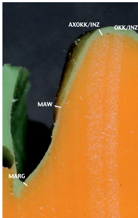
Abb. 9: Replika geschnitten: Durch die Transversal- und Horizontalschnitte wurde eine lokale Schichtstärkenermittlung ermöglicht. In der vorliegenden Untersuchung wurde an folgenden vier Lokalisationen gemessen: [MARG] = Marginal; [MAW] = Mitte axiale Wand; [AXOKK/INZ] = Übergang axiale Wand – okklusales / inzisales Plateau; [OKK/INZ] = Mitte okklusales / inzisales Plateau.
